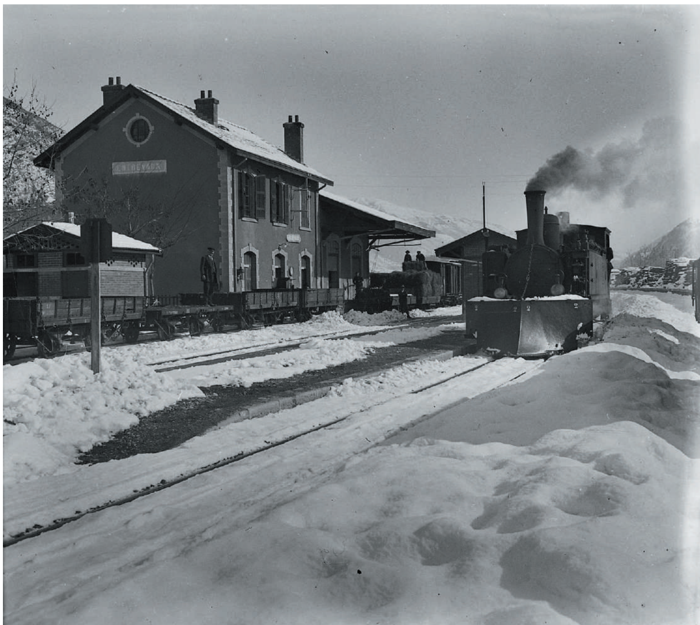
Locomotive équipée d'un chasse-neige devant la gare d'Entrevaux. Coll. privée, avec l'aimable autorisation de la commune d'Entrevaux.
