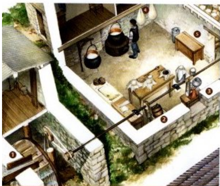
Vacherie de Vignols : 1. roue à aubes, 2. baratte, 3. écrémeuse, 4. sac à brousse, 5. bac à brousse. Dessin J.-B. Héron.
