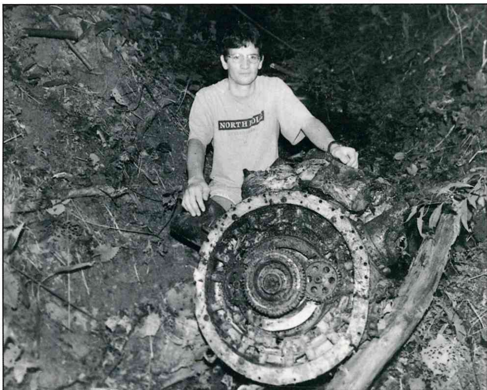
Ce qu'il reste aujourd'hui de l'épave de l'avion du capitaine canadien Jean-Marie Aubert, qui s'est écrasé en 1944 dans le vallon de Gouare (lieu-dit Speggi) à Tende. Il s'agissait d'un avion P47 Thunderbolt. Le moteur, visible ici est un Pratt-et-Whitney R.2800 de 2200 chevaux. Monsieur P. Castellano, visible sur le cliché, nous donne un aperçu de la taille de l'épave. Photo F. Suppo
