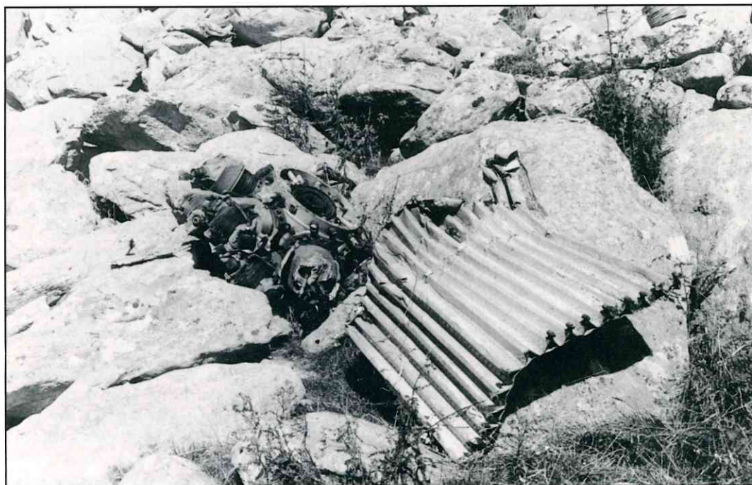
Dans l'éboulis rocheux, une partie de ce qui était une porte de soute à bombes et un des quatre moteurs (quatorze cylindres en étoile de 1200 ch) Pratt et Withney R1830 du B24 de la Céva.. Photo P. Castellano
