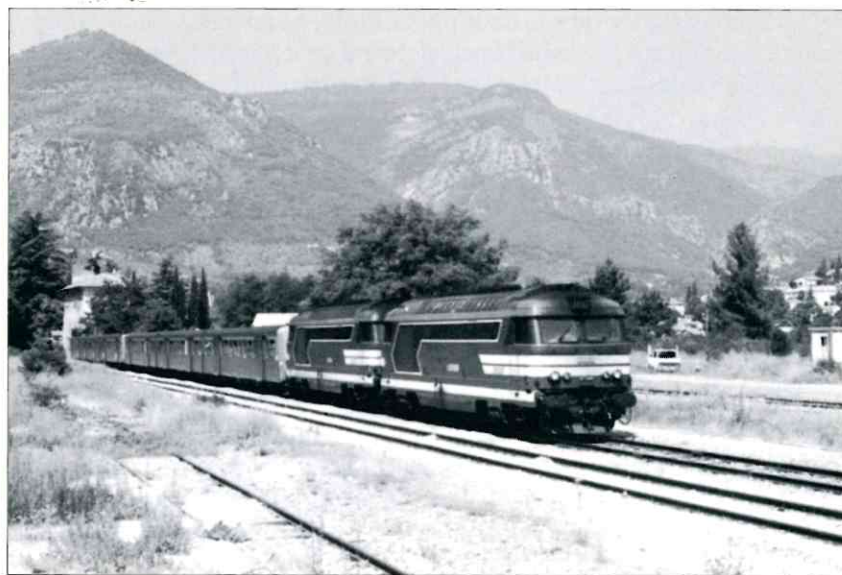
Un des très rares trains spéciaux d'excursion qui ait circulé ces dernières années entre Nice et Breil passe à Sospel le 3 juillet 1999. On voit au premier plan l'ancienne voie de croisement qui a été «débranchée» dans le cadre des travaux de modernisation de la ligne, afin d'éliminer une cause de ralentissement et réduire les temps de parcours. Pourtant, la suppression de cet équipement qui serait utile pour fluidifier le trafic ne s'est pas traduite dans les faits par un gain de temps appréciable... Photo Yann DUVIVIER
