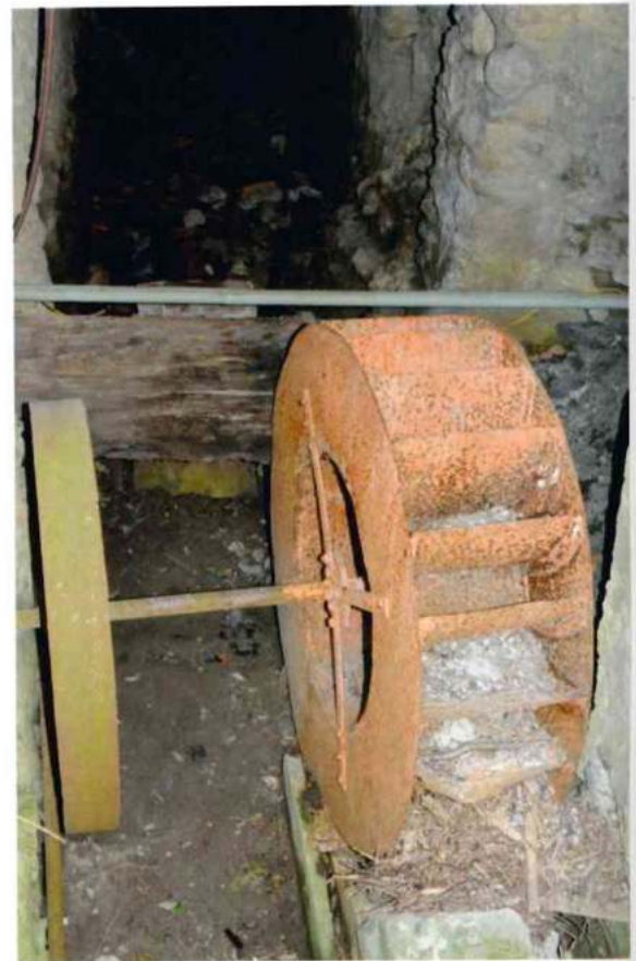
A droite : La roue métallique de 1,50 m qui action- nait le martinet. Pho- tos José BANAUDO
