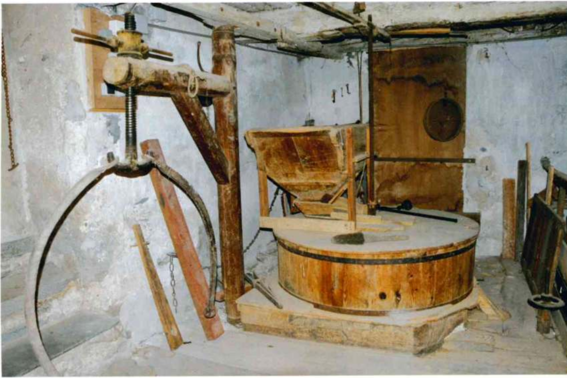
Ci-dessus : La cuve à moudre le blé, avec sur la gauche le palan à vis servant à extraire la meule.
