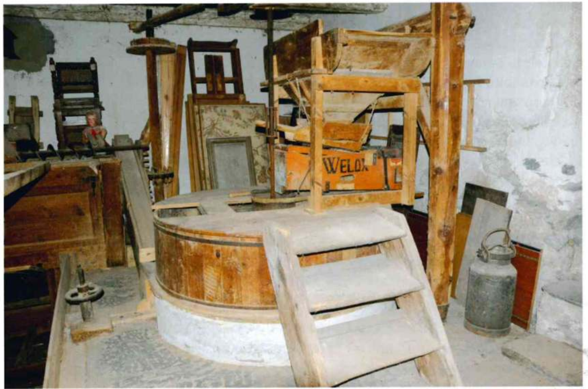
Ci-contre : la cuve à moudre le maïs, avec la trémie et l'épurateur Welox. Ensemble des photos José BANAUDO
