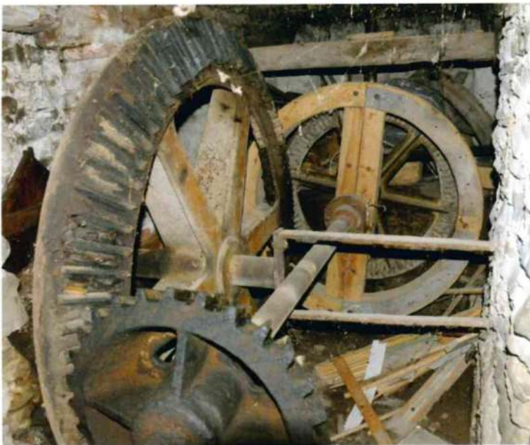
Ci-dessous : Dans le soubassement du moulin, ces engre- nages servent à embrayer l'une ou l'autre des meules sur l'arbre moteur de la roue à aubes.
